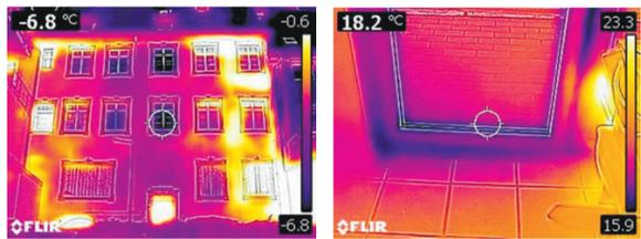
Mit einer Wärmebildkamera können Sie erste Anhaltspunkte zu Kältebrücken oder zum Zustand Ihrer Gebäudehülle und zur Dämmung sammeln. Zu diesem Zweck verleiht der Arbeitskreis Energie Endingen (AKE) eine Wärmebildkamera. Diese kann über das städtische Klimaschutzmanagement ausgeliehen werden.
